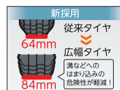
タイヤの接地面積が 従来タイヤよりアップ
